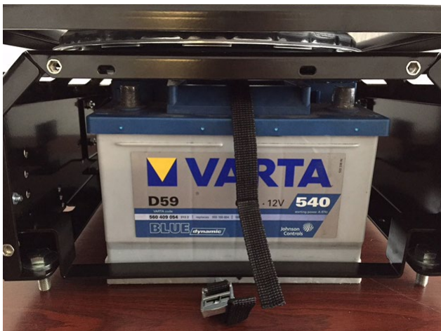
7 Batterie mit hinterer Halterung fixieren.
