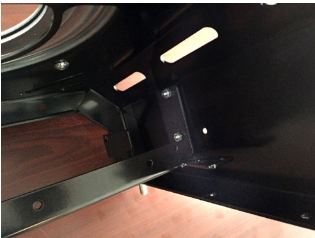
3 Halterung mit den mitgelieferten Schrauben am Sitzkasten befestigen. Halterung kann auch alternativ für den originalen VW CD-Wechsler genutzt werden.
