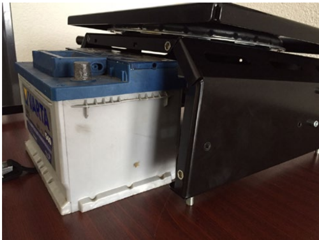
5 Batteriepole anschließen und die Batterie in den Sitzkasten schieben.
